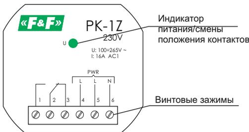
Реле электромагнитное PK-1Z выполнено в корпусе для крепления в монтажную коробку Ø60 мм. На передней панели находится индикатор питания/смены положения контактов исполнительного реле.
