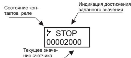
Новый цикл счетчика может быть начат только после обнуления значения счетчика при помощи меню, кнопки RESET или внешнего входа обнуления. Для предотвращения случайного обнуления значения счетчика, само обнуление происходит лишь при условии что кнопка RESET (или внешний вход обнуления) нажата (подключен) на протяжении 3 сек.
