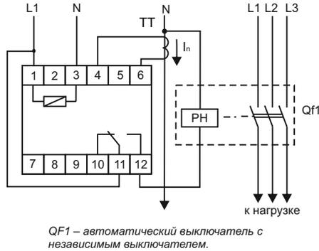
Схема подключения без расцепителя.
