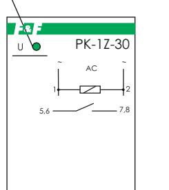
Реле электромагнитное PK-1Z-30 выполнено в двухмодульном корпусе для крепления на DIN-рейку 35мм. На передней панели находится индикатор питания/смены положения контактов исполнительного реле.
